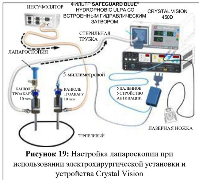
**Рисунок 19:** Настройка лапароскопии при использовании электрохирургической установки и устройства Crystal Vision
